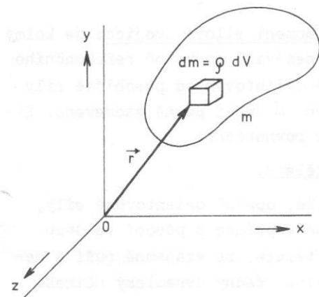
Představa tělesa složeného z malých elementů objemu  $dV$ . Hmotnost tohoto elementu je
